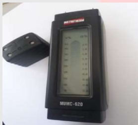
Medidor modelo Instrutherm – Modelo MUMC 620. Na medição temos a leitura de 10% e no máximo de 100%.
